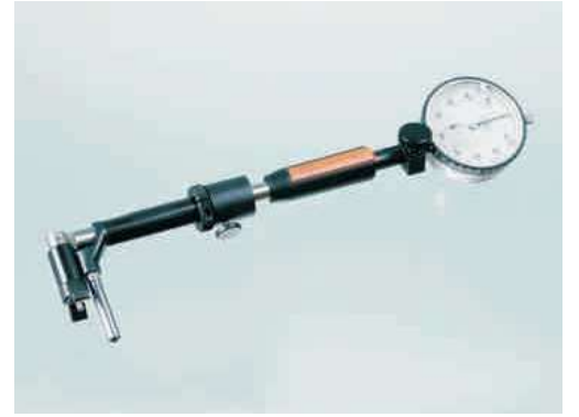
SUBITO® ST içeri dönük sabit ölçüm ucu
