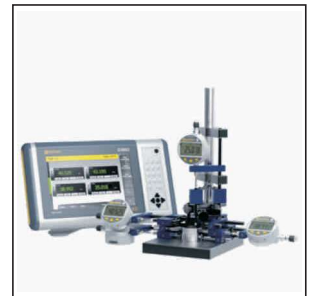
D300S'e BT ile bağlı komparatörler
