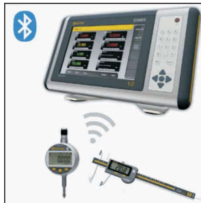
BT ile çoklu cihaz bağlantısı
