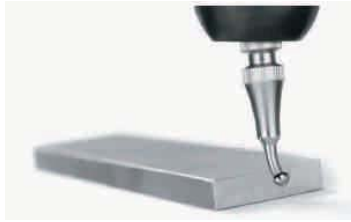
Seviye 1 – kırılma noktası 1 (= dar prob ucun bükülmesi)
