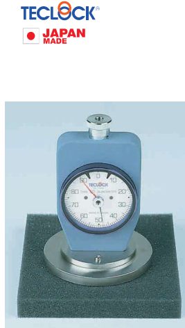
Sertlik GS- 744 G'nin sünger plaka üzerine konulmasıyla ölçülür. Polistiren tabaka dağılımına karar verilir.
