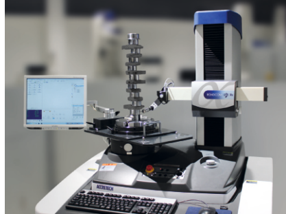
Özel kalibre aleti kullanan ölçüm krank milinin bir örneği
