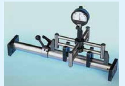
ESU Sıfırlama Ayar Cihazı; OD çapraz kovan / ayarlı çapraz kovanlı modeller içindir.
