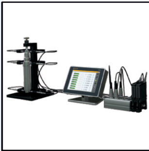
D400 S ile bağlantılı M-Bus çoğaltıcıya bağlanan indüktif ve Solartron problemler.
