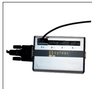
MB-4D'ye bağlanan dijimatik cihazlar
