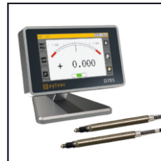
D70S gösterge ünitesine bağlanan indüktif problemler
