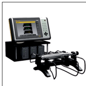
D302 çoğaltıcı ünite ile D300S'e bağlanan problemler
