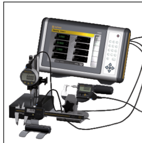
D300S ünitesine toleransların canlı renklerle gösterimi ile bağlanan çeşitli cihazlar
