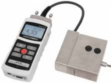
Stand dışında kalibrasyon amaçlı M51 indikatöre AC1083 adaptör ile bağlı FS05 serisi kuvvet sensörü.
