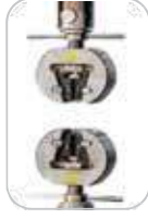
Çekme çenesi Yuvarlak: \Phi 4 - \Phi 9 , Düz: 0-7 mm
