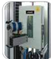
Yüksek ve Düşük Sıcaklık test kabini çalışma sıcaklığı 70°C~280°C(kompresör) 100°C~280°C(sıvı azot)
