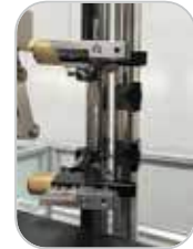
Uzun mesafe ekstensiyometre Model DBX-800 Tekstil ürünleri , plastikler ve kauçuklar için.
