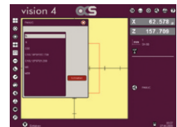
CNC kontrol ünitesine veri aktarımı için PP (opsiyonel) master
