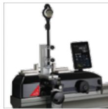
2 noktalı iç çap ölçüm cihazlarının standında kalibrasyonu
