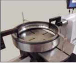
Rulman halkasının CNC kontrollü dahili ölçümü
