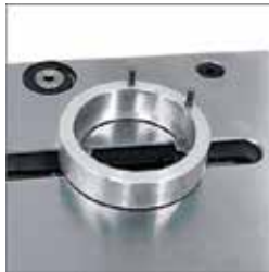
İç kanalların ölçümü (TELS10)
