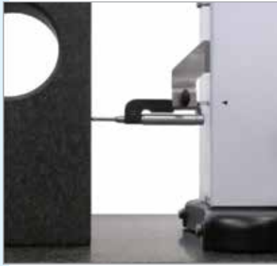
Elektronik prob ile diklik ölçümü (TA-IH-126, TA-MS-101)
