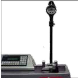
Analog kadran göstergeli 2 noktalı iç çap ölçüm cihazlarının ayarlanması
