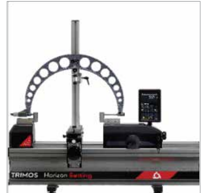
Büyük mikrometrelerin destek üzerinde ayarlanması (TA-SU-313, TA-SU-309, TEL5) (.LABC20.1/SP02, TEL5)
