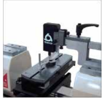
Tampon masterlarının kalibrasyonu (TA-SU-313/ABC70/TA-SU-354)
