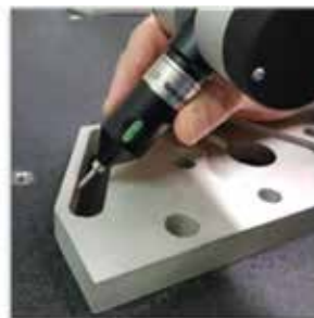
Prob üzerindeki düğmelerle ölçüm hassasiyetinizi artırın
