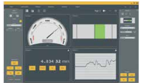
Renk kodlarıyla ayrılan toleransların çoklu kanalda gösterimi
