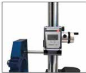
Merkezden mesafelerin ölçümü (TVM5)
