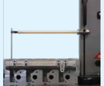
Uzun Prob Mükemmel tekrarlanabilirlik ile 400 mm'ye kadar standar ölçüm uçları
