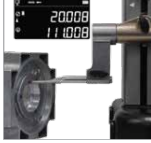
Çap ve merkezlerin eş zamanlı gösterimi (TA-IH-135, TA-MI 101)
