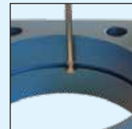
930.2108, 930.2110 ve 905.2205 aksesuarlarla iç kanal ölçümü
