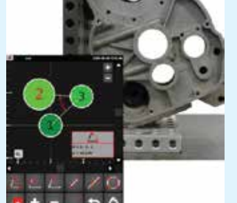
Deliklerin grafiksel görselleştirilmesi sayesinde son derece basit 2D ölçüm
