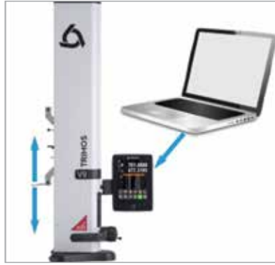
Cihaz bir PC aracılığı uzaktan kontrol edilebilir.
